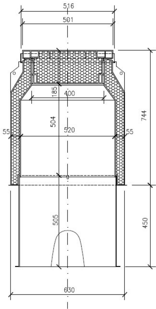
**Řez šachtou DANWELL se zvýrazněnou izolací (jednotlivé části) M 1:10**
